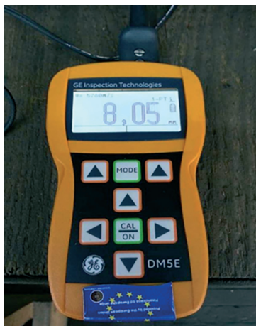
Slika 34. Uređaj za ultrazvučno mjerenje debljine stijenke [9]
