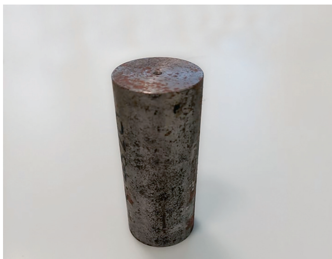
Slika 14. Čelik zahvaćen korozijom [9]
